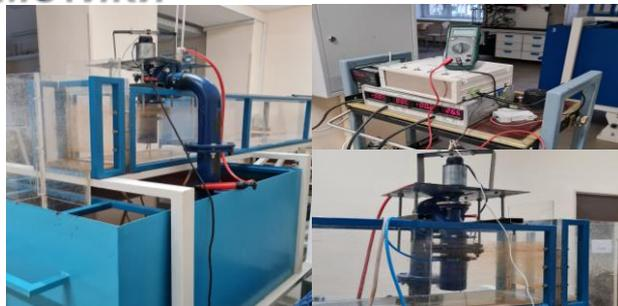
Применение имитации «кожи акулы» на входной кромке лопасти центробежного насоса позволило достичь повышения гидравлического КПД на 1-1,5%.
