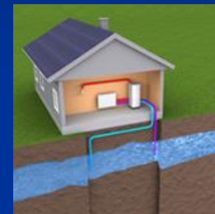
коллектор грунтовых вод
