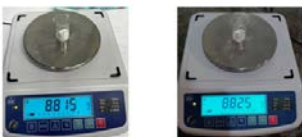
Рисунок 3 – Взвешивание сосуда с H_2O до и после сбора влаги
