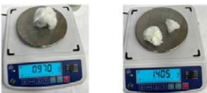
Рисунок 2 – Взвешивание впитывающего материала до и после сбора влаги
